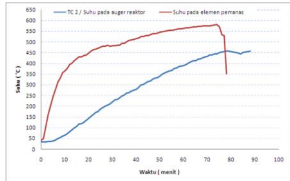
Gambar 4. Grafik suhu pada elemen pemanas dan auger reaktor dengan set point 450°C
